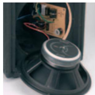
► Vue sur le filtre passif et sur le boomer de la A12.
